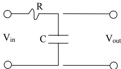
Fig. 1. The RC Circuit.
