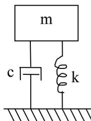
**Fig. 6. The SDOF Mass-Spring-Dashpot.**
