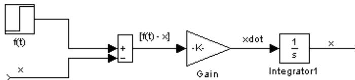
**Fig. 4. Integrating the output signal.**
